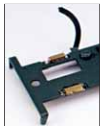
▼ ▶ Treibradsatz und Blindwelle werden ungefedert montiert, wofür 0,8-mm-Klötzchen die Treibachse in den Lagern fixieren.
